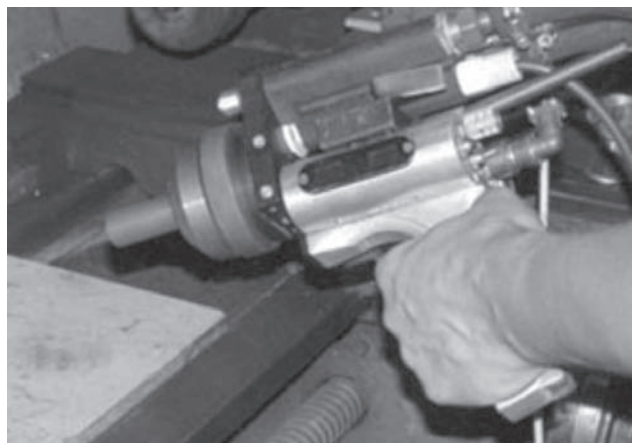
Рисунок 1 — Внешний вид термораспылителей: а — порошковый ОИМ 050; б — шнуровой ТЕРКО-ПШ
